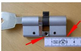
Im ausgebauten Zustand lässt sich das Zylindermaß am besten messen. Messen Sie zuerst die Außenseite des Schließzylinders, indem Sie von der Mitte des Gewindelochs bis zum Zylinderende der Außenseite messen. Bei unserem Beispiel ist das Außenmaß 30 mm.
