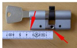
Messen Sie die Innenseite des Schließzylinders, indem Sie von der Mitte des Gewindelochs bis an das Zylinderende der Innenseite messen. In unserem Beispiel sind das 35 mm.
